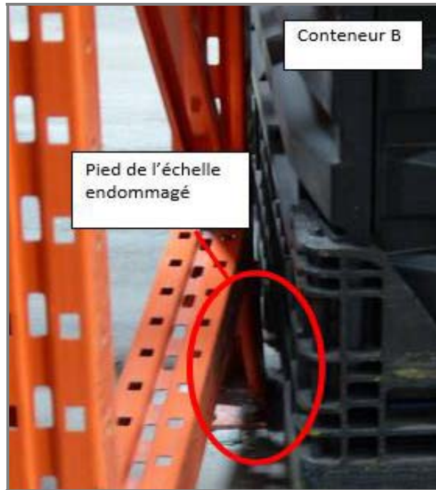
Photo 6 : Pied de l'échelle endommagé Source : CNESST
