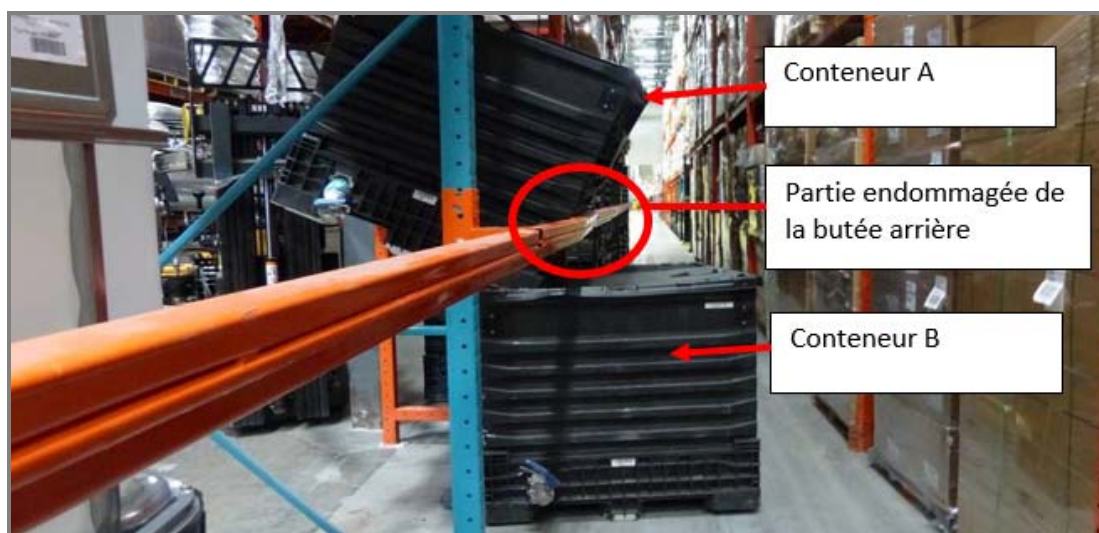
Photo 5 : Butée arrière endommagée de l'alvéole 12 A Empiètement du conteneur B dans l'allée derrière l'alvéole 12 A Source : CNESST
