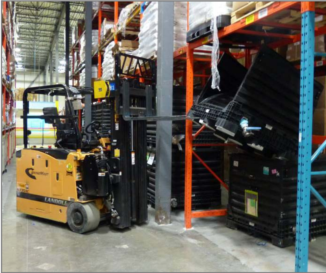
Photo 3 : Chariot élévateur à conducteur assis utilisé pour soulever le conteneur A Source : CNESST
