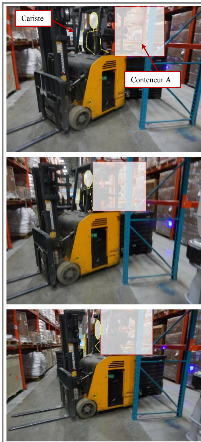
Figure 4 : Reconstitution approximative de la collision du chariot 380 avec des conteneurs Source : CNESST
