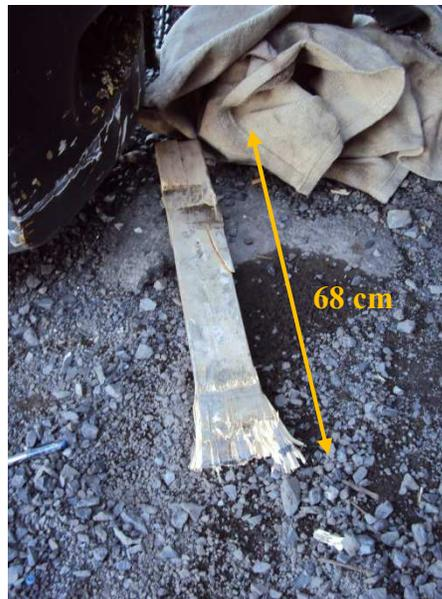
Photo 12 : Morceau de bois ayant servi aux tentatives de freinage de la locomotive retrouvé entre l'arrière du chariot élévateur et le côté gauche de la locomotive.
