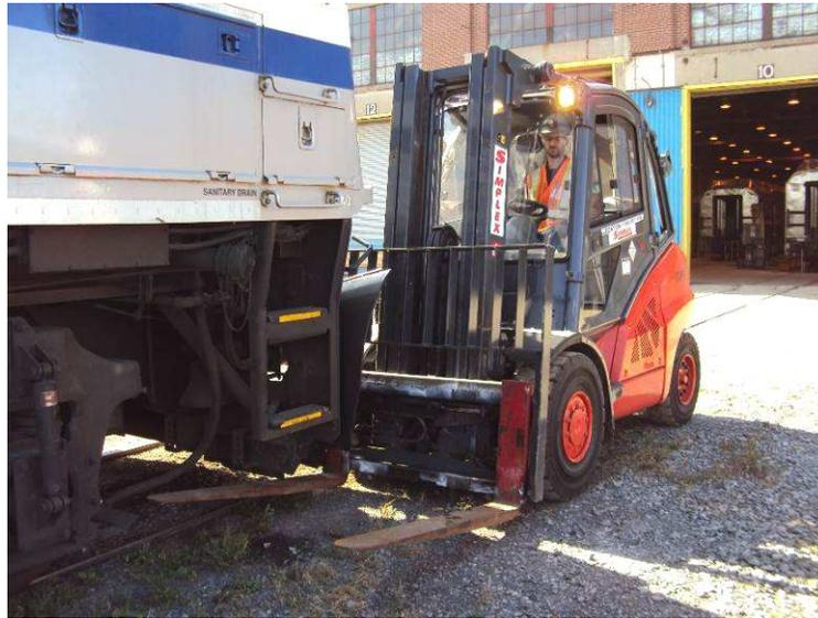
Photo 16 : Simulation de la méthode pour tirer une locomotive avec un chariot élévateur.
