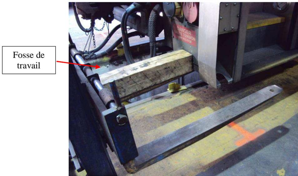
Photo 15 : Simulation de la méthode pour pousser un matériel roulant avec un chariot élévateur et un morceau de bois.
