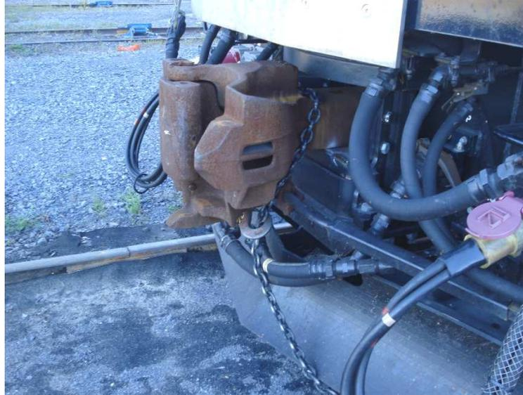
Photo 10 : Chaîne enroulée autour de l'attelage avant de la locomotive 1360.
