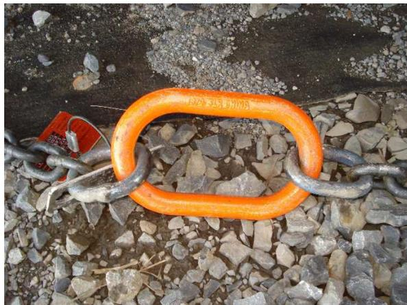
Photo 9 : Anneau central de la chaîne utilisée pour tirer la locomotive 1360.
