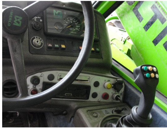
Figure 27 : Le levier de commande et le tableau de bord du véhicule impliqué dans l'accident (Source : CSST)
