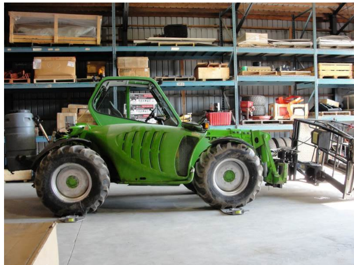
Figure 11 : Véhicule Merlo vue du côté droit (Bras rétracté et non incliné) (Source : CSST)
