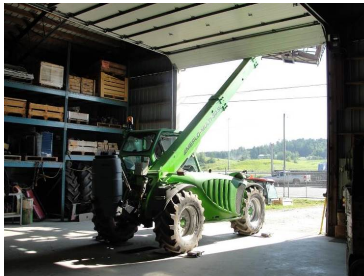
Figure 13 : Véhicule Merlo vue de l'arrière droit (Bras déployé de 6 m (20 pi) et à un angle de 60°) (Source : CSST)
