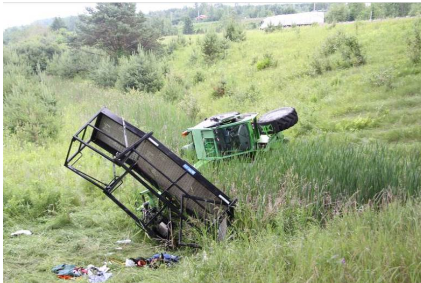
Figure 16 : Plate-forme PTE.ZM2 ouverte (endommagée) (Source : CSST)
