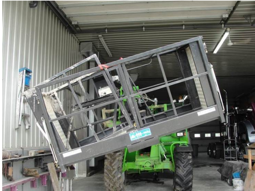
Figure 15 : Plate-forme PTE.ZM2 repliée (endommagée) : (Source : CSST)
