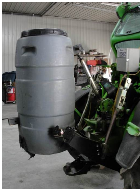
Figure 19 : Le contre poids installé sur le véhicule Merlo impliqué dans l'accident (Source : CSST)
