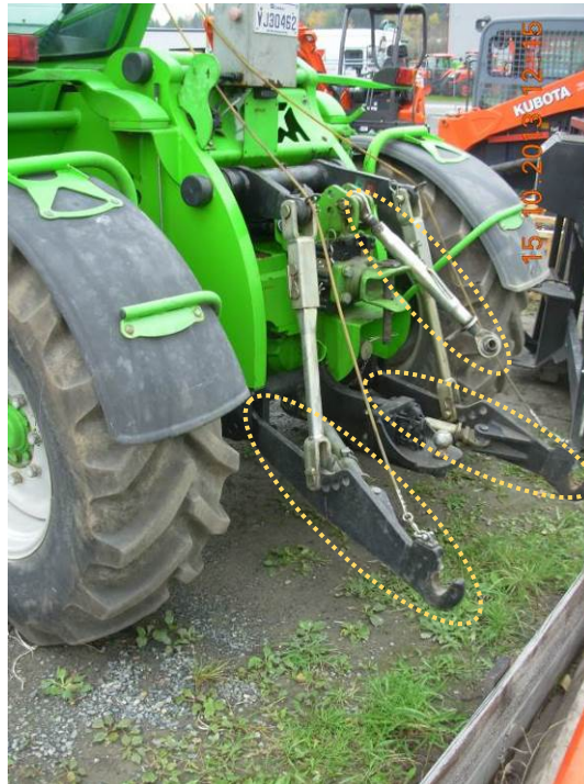
Figure 18 : Le système d'attelage à trois points d'attache (Source : CSST)
